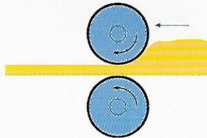
Cilindros de acero de 165 mm de diámetro y velocidad periférica ideal para un refinamiento perfecto del bastón sin dañar la masa.
